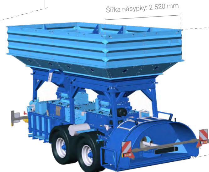
Rozměry sestavy s tunelem
